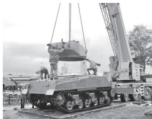
Для восстановления танка были проделаны следующие работы: вскрыт десантный люк и промыв корпус танка изнутри, были очищены башня и корпус; изготовлены недостающие ведущие звезды по образцу, а также катки, пружины, гусеничные траки и оси. Были изготовлены и установлены макеты глушителей, недостающие кожухи; башня танка была закреплена на корпусе, ствол пушки уложен в стойку; корпус танка был выкрашен в темно-зеленый цвет.
